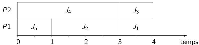
FIGURE: Diagramme de Gantt de l'exemple, C_{max}^* = 4
